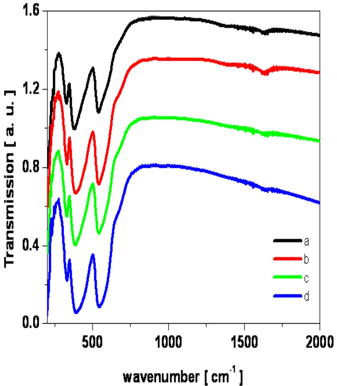
Figure 6.5: IR spectra of ZnFe<sub>2</sub>O<sub>4</sub> nanoparticles annealed at (a) 300<sup>o</sup>C, (b) 400<sup>o</sup>C, (c) 500<sup>o</sup>C and (d) 600<sup>o</sup>C temperatures.
