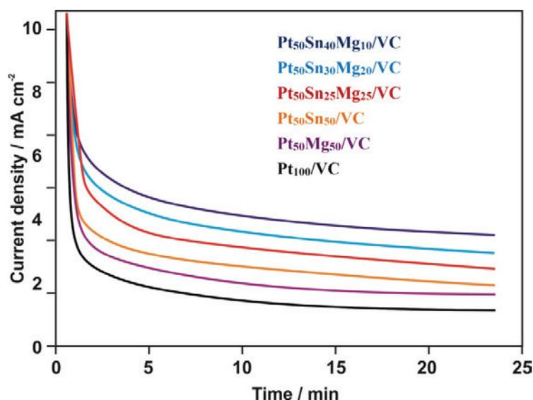
**Fig. 4.6 CA of Pt<sub>50</sub>Sn<sub>40</sub>Mg<sub>10</sub>/VC, Pt<sub>50</sub>Sn<sub>30</sub>Mg<sub>20</sub>/VC, Pt<sub>50</sub>Sn<sub>25</sub>Mg<sub>25</sub>/VC, Pt<sub>50</sub>Sn<sub>50</sub>/VC, Pt<sub>50</sub>Mg<sub>50</sub>/VC and Pt<sub>100</sub>/VC nanoparticles.**
