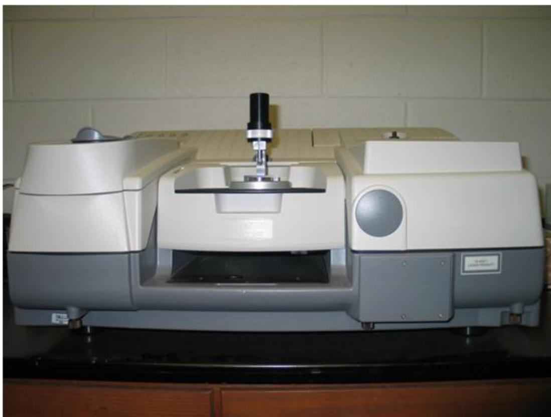
Fig. 2.4.2. FTIR spectrometer
