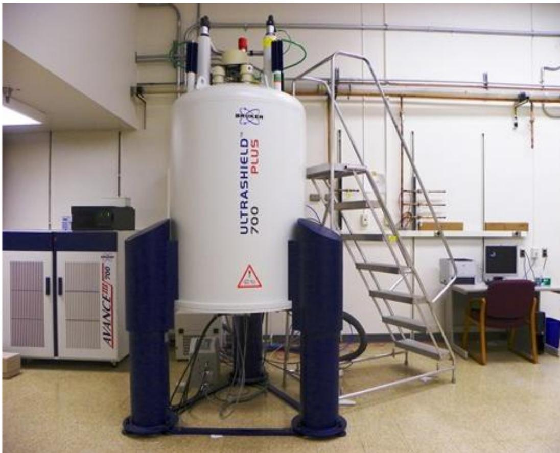
Fig. 2.4.3. NMR spectrometer
