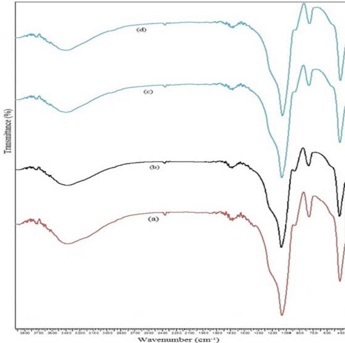
**Fig. 3.5:** FTIR spectra of  $\text{CoFe}_2\text{O}_4:\text{SiO}_2$  nanocomposites (a) as-prepared (b)  $250^\circ\text{C}$  (c)  $500^\circ\text{C}$  and (d)  $750^\circ\text{C}$
