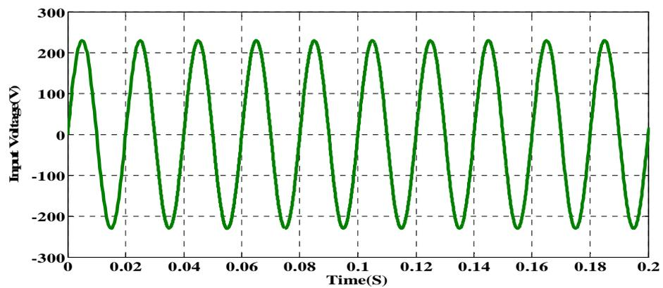
**Figure 3.4 AC input to the rectifier**
