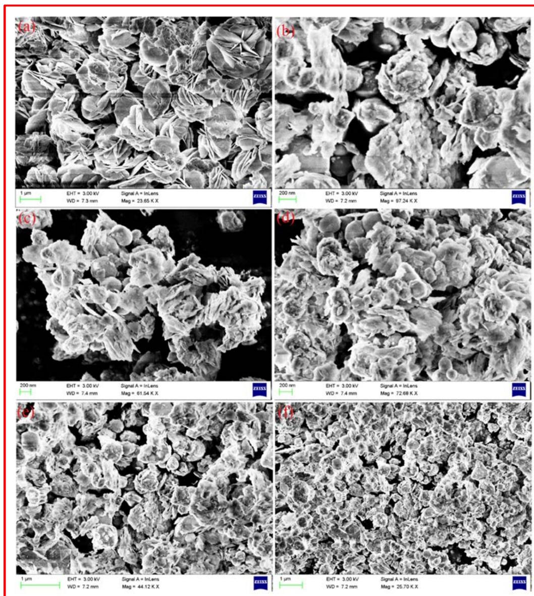
**Fig. 4.2:** SEM images of: (a) BiOBr, (b) AB1, (c) AB3, (d) AB5, (e) AB7, and (f) AB9.
