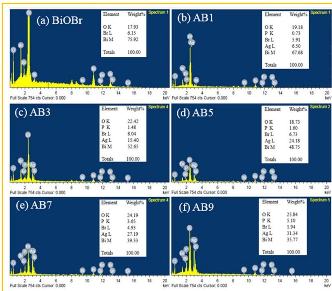
**Fig. 4.3:** EDS spectrum of: (a) BiOBr, (b) AB1, (c) AB3, (d) AB5, (e) AB7, and (f) AB9.
