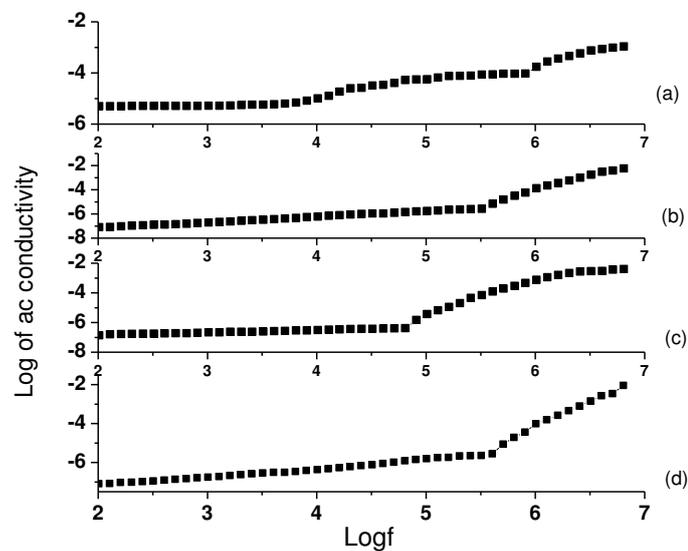
**Figure (3.22): Jonscher’s plot (a)  $\text{PbC}_4\text{H}_4\text{O}_6 \cdot 2.4\text{H}_2\text{O}$  sample-1 (b)  $\text{Pb}_{0.989}\text{Fe}_{0.011}\text{C}_4\text{H}_4\text{O}_6 \cdot 1.9\text{H}_2\text{O}$  sample-3, (c)  $\text{Pb}_{0.993}\text{Fe}_{0.007}\text{C}_4\text{H}_4\text{O}_6 \cdot 0.5\text{H}_2\text{O}$  sample-4 and (d)  $\text{Pb}_{0.994}\text{Fe}_{0.006}\text{C}_4\text{H}_4\text{O}_6 \cdot 0.17\text{H}_2\text{O}$  sample-5**
