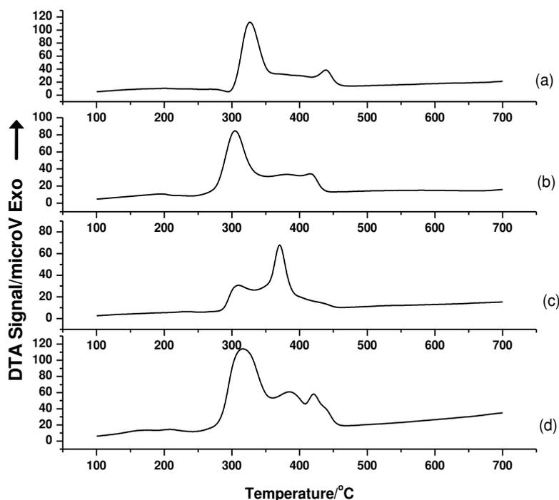
**Figure (3.9): DTA curves of (a) Sample 1.  $\text{PbC}_4\text{H}_4\text{O}_6 \cdot 2.4\text{H}_2\text{O}$  (b) Sample 3.  $\text{Pb}_{0.989}\text{Fe}_{0.11}\text{C}_4\text{H}_4\text{O}_6 \cdot 1.9\text{H}_2\text{O}$  (c) Sample 4.  $\text{Pb}_{0.993}\text{Fe}_{0.007}\text{C}_4\text{H}_4\text{O}_6 \cdot 0.5\text{H}_2\text{O}$  and (d) Sample 5.  $\text{Pb}_{0.994}\text{Fe}_{0.006}\text{C}_4\text{H}_4\text{O}_6 \cdot 0.17\text{H}_2\text{O}$**
