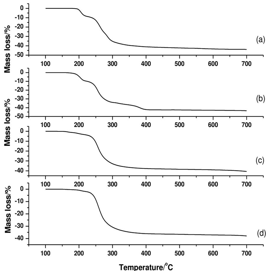
**Figure (3.8): Thermo-grams of (a) Sample 1.  $\text{PbC}_4\text{H}_4\text{O}_6 \cdot n\text{H}_2\text{O}$  (b) Sample 3.  $\text{Pb}_{0.989}\text{Fe}_{0.011}\text{C}_4\text{H}_4\text{O}_6 \cdot n\text{H}_2\text{O}$  (c) Sample 4.  $\text{Pb}_{0.993}\text{Fe}_{0.007}\text{C}_4\text{H}_4\text{O}_6 \cdot n\text{H}_2\text{O}$  and (d) Sample 5.  $\text{Pb}_{0.994}\text{Fe}_{0.006}\text{C}_4\text{H}_4\text{O}_6 \cdot n\text{H}_2\text{O}$**
